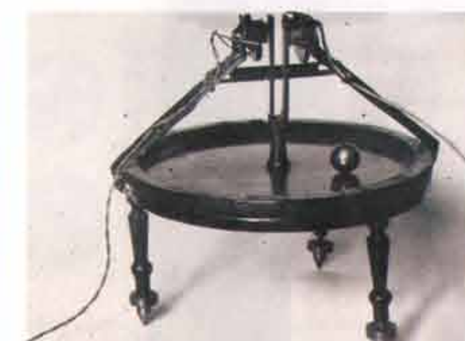
Utertone Productor . Instrument acoustique expérimental construit par le GIMN pour explorer le phénomène des sous-harmoniques et harmoniques inférieures, milieu des années 1920 / Experimental acoustical device built at GIMN to explore phe- nomena of subharmonics and so called utertones , mid-1920s Theremin Center Archive, Moscou / Moscow
